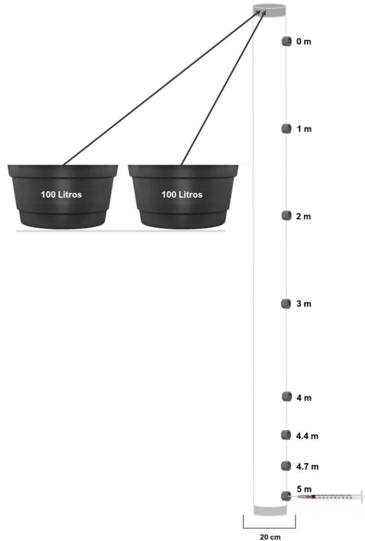
Figura 5. Ilustração do sistema experimental. Será utilizado um tubo de PVC de 20 centímetros de diâmetro e 5,5 metros de comprimento. Para a injeção e coleta de amostras de eDNA serão instalados septos cromatográficos com o objetivo de simular diferentes alturas da coluna d'água (0, 0,3, 0,6, 1, 2, 3, 4 e 5 m). Duas caixas d'água de 100 litros serão utilizadas como reservatório de água.
